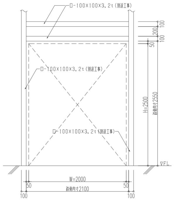
下地鉄骨寸法図 s=1/30
