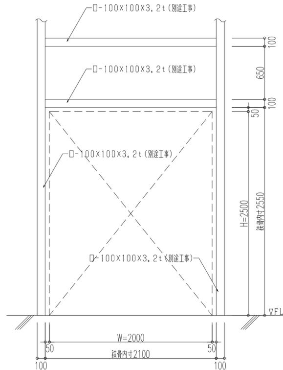
下地鉄骨寸法図 S=1/30
